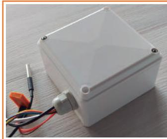
Figura 6. Carcasa que resguarda el circuito eléctrico de la estación meteorológica
