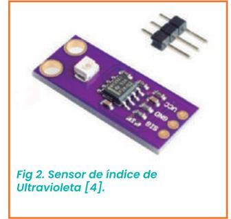
Fig 2. Sensor de índice de Ultravioleta [4].
